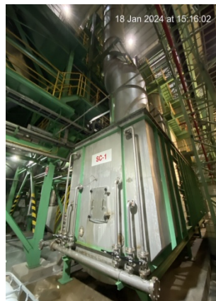
ปล่อง Spray Dryer Burner
